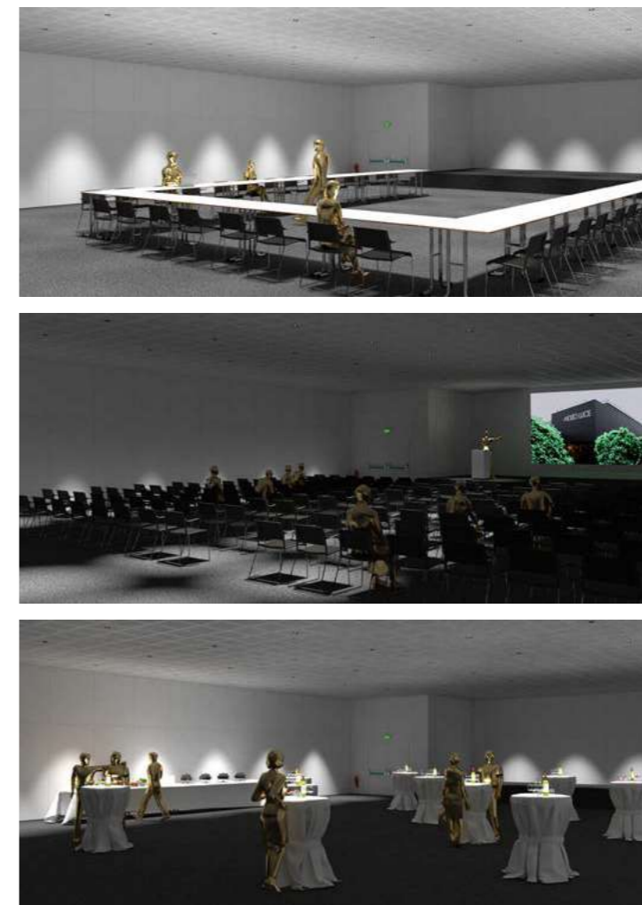
Beispiel mit Strahlerabstand 2,5m / Example with spot distance 2,5m
